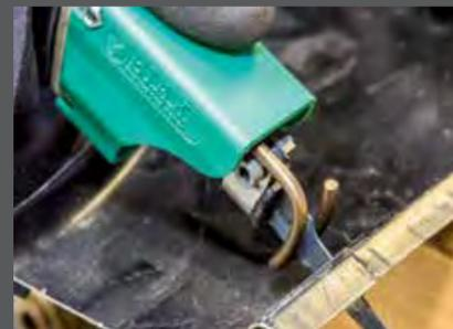
Unsere Druckluftsägen sind besonders geeignet für Trennarbeiten an der Karosserie und im Stahlblech. Auch für andere Materialien wie Aluminium, Buntmetalle, Nichteisenmetalle, Plastik, Holz oder Verbundstoffe führen wir die passenden Sägeblätter im Sortiment. Unsere Druckluftsägen basieren auf den legendären SIG-Sägen und werden an unserem Schweizer Standort in Neuhausen am Rheinfluss gefertigt.
