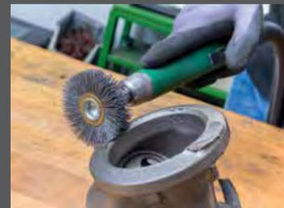
Unsere Bohrmaschinen sind leicht aber dennoch durchzugsstark und haben einen ergonomischen Griff. Es gibt sie in verschiedenen Geschwindigkeitsstufen. Die Bürstmaschinen gibt es in gerader oder gewinkelter Ausführung. Sie zeichnen sich durch niedrige Drehzahlen und ein hohes Drehmoment aus. Sie eignen sich insbesondere zur Entfernung loser Grate oder der Reinigung von Oberflächen.
