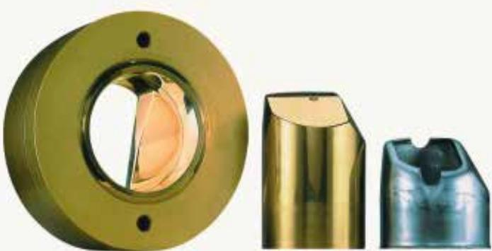
slijtvaste nitreerlaag, ook wel verbindingslaag genoemd, opgebouwd. De dikte van de verbindingslaag is geringer al naargelang het materiaal hoger met vooral Cr, Mo en Al gelegerd is, en de gekozen nitreertijden korter zijn. De dikte kan in de praktijk variëren van 0,1 tot 0,6 mm diepte (procestdijken van 2 tot 100 uren). De bereikbare oppervlaktehardheid ligt boven de 1.000 HV (komt overeen met ongeveer 70 tot 72 Hrc).
